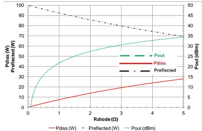
Fig. 1-(b)  $P_{out}$ ,  $P_{diss}$  &  $P_{reflected}$  vs.  $R_{diode}$ ;  $P_{in}=100\text{W}$ ; (Equations 1-3)
